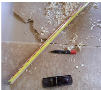
Kuva 11. Laidunkepin yhteen kylkeen tehdään mitta-asteikko ja toiseen merkitään täplät tiheyden arvioimiseksi. Kuvat: Pyy Saارينen.
