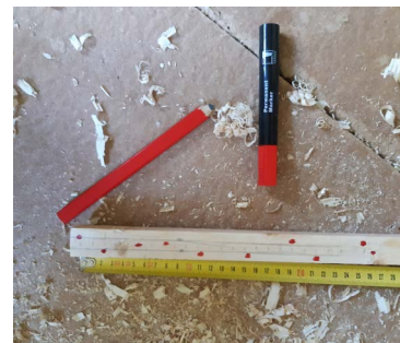
Kuva 11. Laidunkepin yhteen kylkeen tehdään mitta-asteikko ja toiseen merkitään täplät tiheyden arvioimiseksi. Kuvat: Pyy Saارينen.
