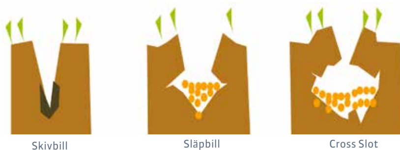
Bearbetningsprofil från olika såmaskiner. Illustration: Tuomas Mattila, utgående från Baker m.fl. 2006.
