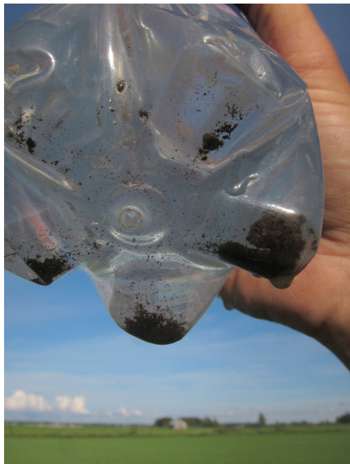
Att uppskatta aggregatstabiliteten med hjälp av flasktest. Bild: Jukka Rajala.
