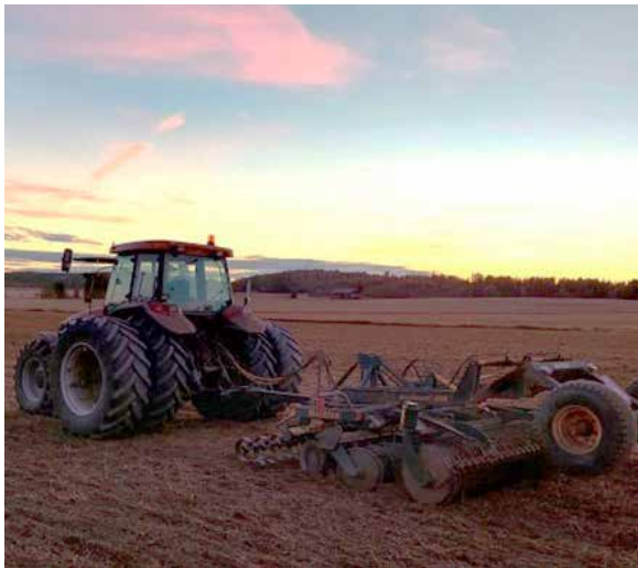
Sänkimuokkaus esimerkiksi kultivaattorilla, lautasäkeellä tai lapiorullaäkeellä pätkii juolavehnan ja valvatin sekä muiden kestorikkakasvien juurakoita heikentäen niitä. Kuva: Ville Malin.
