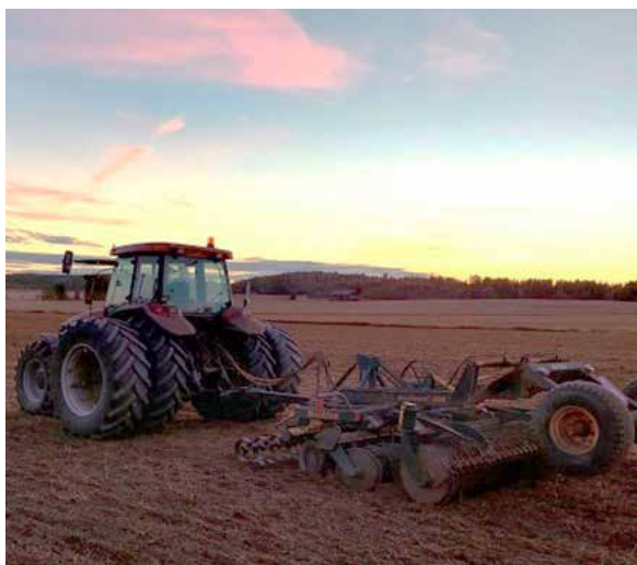
Stubbearbetning med t.ex. kultivator, tallriksharv eller spadruullharv trasar sönder jordstammen hos kvickrot, molke och andra fleråriga ogräs så att den försvagas. Foto: Ville Malin.
