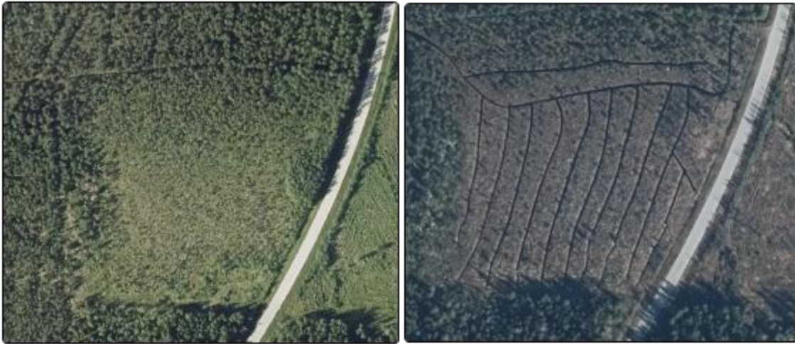
Kuva 5. Uudisojitettu kohde ennen (vasen 2021) ja jälkeen (oikea 2024) uudisojituksen.
